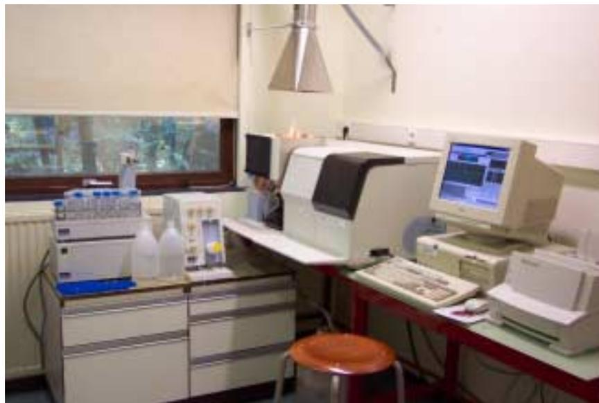
**Fig. 10** : Le spectrophotomètre d'absorption atomique.
